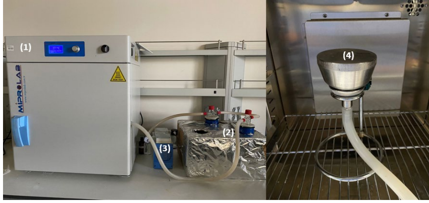
Şekil 1. Pervaporasyon ünitesi (1)etüv, (2) tuzaklar (3) vakum pompası (4) çelik membran hücresi
