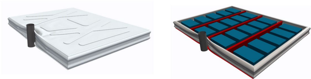
Şekil 7: DP800 Malzemedeki Tasarlanan Batarya Kutusuna Yapılan Yandan Çarpma Analiz Simülasyonu
